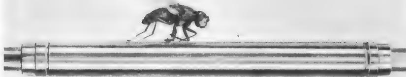
Bild 1. Die minimalen Abmessungen (knapp 40 mm Länge, 4 mm Durchmesser) des Verstärkers werden im Größenvergleich mit einer gewöhnlichen Stubenfliege deutlich
